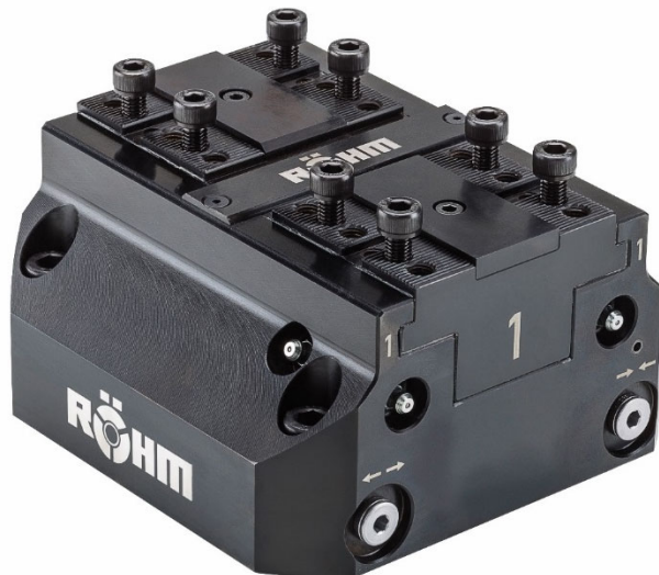
Abb. 2: Neben kompakter Bauweise und hoher Wiederholgenauigkeit überzeugen die KZS Zentrischspanner durch hohe Spannkraften mit bis zu 55 kN, einen vergrößerten Spannbereich von 20% und eine reduzierte Störkontur für optimalen Spänefluss (Bild: Röhм).
