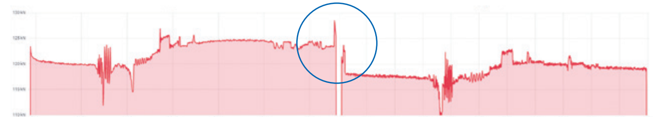
Augmentation de la force de serrage par le déplacement axial lors du transfert de la broche principale (à gauche) à la contre-broche (à droite).
