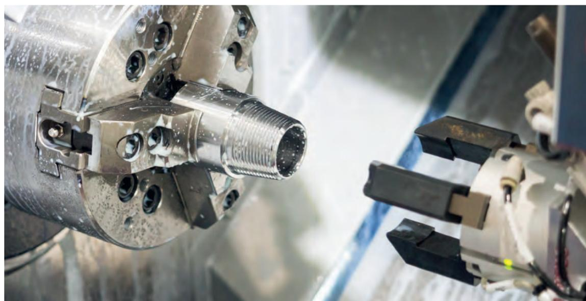
La iJaw mide la fuerza de sujeción entre la mordaza de sujeción y la pieza de trabajo incluso antes del mecanizado. El asiento de la pieza de trabajo en el medio de sujeción influye en la fuerza de sujeción aplicada. La evaluación de la medición de las fuerzas de sujeción aplicadas permite determinar si una pieza de trabajo está asentada correctamente en el medio de sujeción. Según la geometría de la pieza es conveniente o necesario
