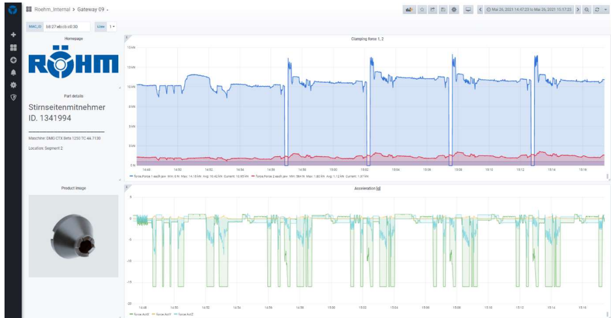
Immagine 7: Realizzazione di dischi di trascinamento iJaw misura la forza di serraggio in tempo reale con 100 Hz durante la lavorazione. I dati vengono inoltrati al gateway e da lì al comando della macchina e/o a un cloud.
