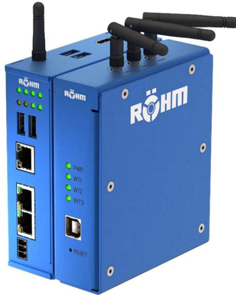
*Abbildung 5: Das Gateway empfängt die Daten von der iJaw über das IO-Link Wireless Protokoll. Über Profinet stehen die Daten direkt an der Maschinensteuerung zur Anzeige an der HMI oder zur Weiterverarbeitung für die Prozesssteuerung bereit. Über LAN können die Daten in eine Cloud gesendet und zur Visualisierung, Dokumentation oder Analyse genutzt werden.*
