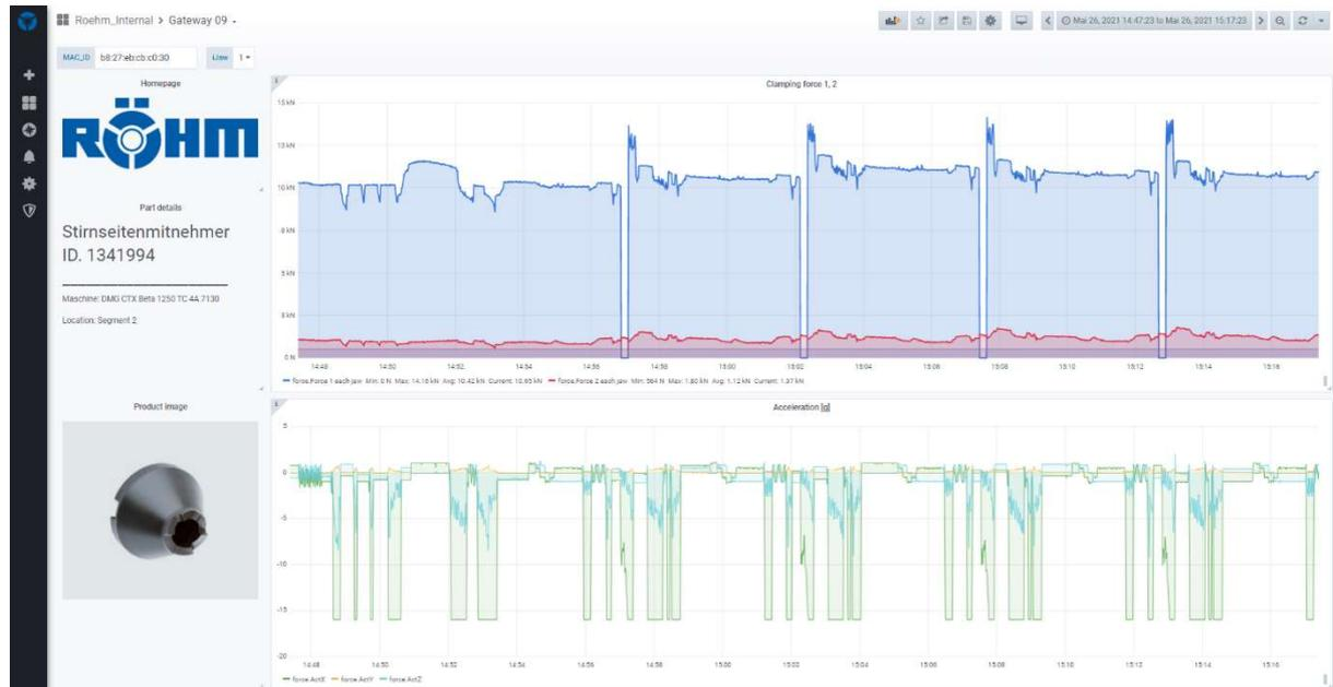
Abbildung 7: Fertigung von Mitnehmerscheiben. Die iJaw misst die Spannkraft mit 100 Hz während der Bearbeitung in Echtzeit. Die Daten werden an das Gateway und vor dort an die Maschinensteuerung und/oder eine Cloud weitergeleitet.
