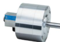
... se impieghi un metodo di serraggio manuale, se non desideri collegare alla macchina un circuito idraulico, ti offriamo i mandrini con cilindro incorporato (LVE) di Röhm. In questo caso un cilindro pneumatico è combinato con il mezzo di serraggio in un unico modulo. Queste combinazioni di cilindro/mandrino sono particolarmente adatte per l'equipaggiamento delle macchine manuali. L'azionamento del pistone avviene mediante sistema pneumatico.
