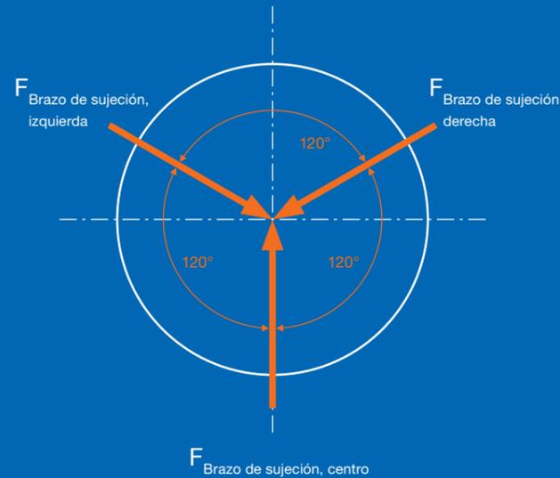
$$F_{\text{Brazo de sujeción, izquierda}} + F_{\text{Brazo de sujeción, derecha}} + F_{\text{Brazo de sujeción, centro}} = 0$$
