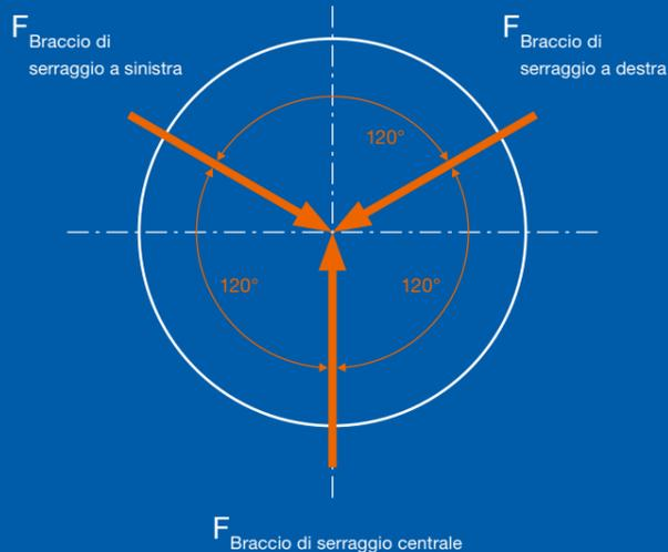
$$F_{\text{Braccio di serraggio a sinistra}} + F_{\text{Braccio di serraggio a destra}} + F_{\text{Braccio di serraggio centrale}} = 0$$
