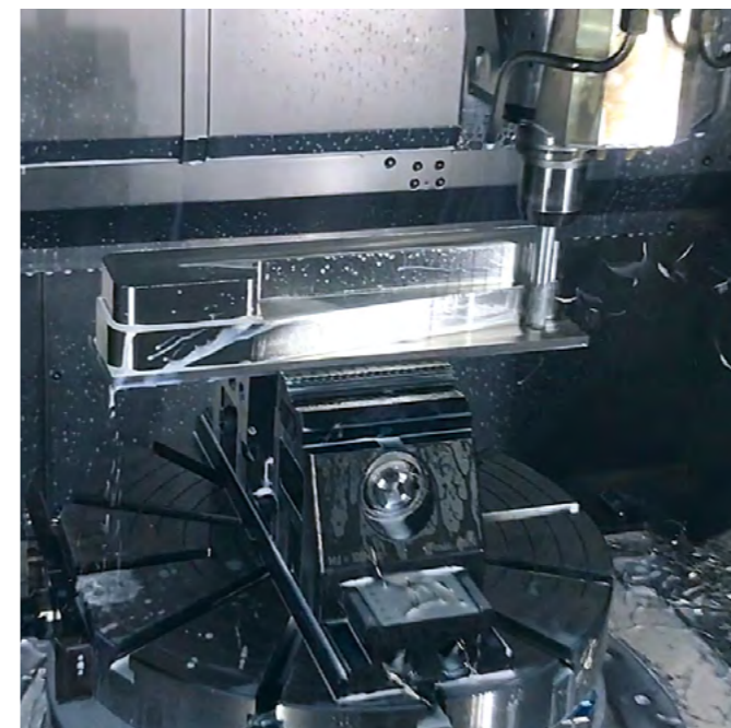
Spannt mühelos Werkstücke verschiedenster Größe und Geometrie: der RVM
