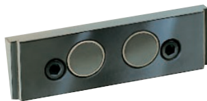
Grundbacken RNG mit Dauermagnet zur Aufnahme von schnellwechselbaren Niederzugspanneinsätzen. Zum Anschrauben an die feste und bewegliche Backe.
