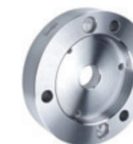
Крепежные фланцы для цилиндров с коротким конусом предлагаются с размерами конуса 5, 6, 8, 11. Резьбовые соединения поставляются в размерах ISO 702-1 (DIN55026, резьбовое соединение), 701-2 (DIN55029, Camlock) и 702-3 (распорная шпилька с гайкой). Фланцы также подходят к CoAE с центрирующим приспособлением.
