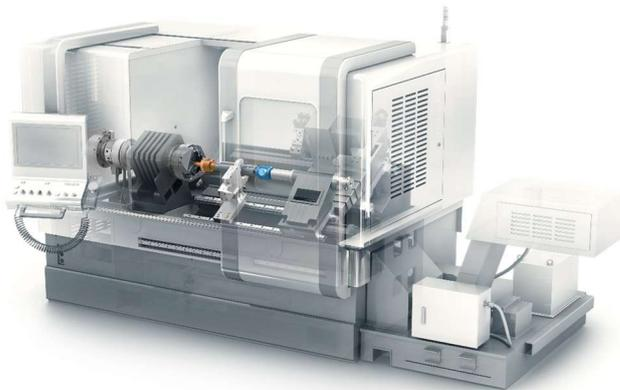
Abbildung 3: Anwendungsprinzip des Stirnseitenmitnehmers CoAE auf einer CNC-Drehmaschine mit Gegenspannung durch Spitze und mittlerer Abstützung mit Lünette
