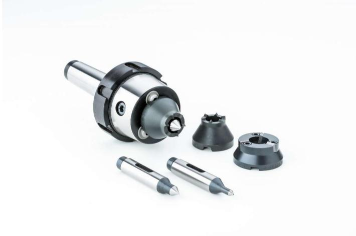
*Abbildung 1: CoAE von Röhmm mit Spitze und Mitnehmerscheibe, Morsekegel und Abdrückmutter, sowie Wechselteilen (zwei verschiedene Spitze, eine Mitnehmerscheibe mit Verzahnung, eine Mitnehmerscheibe mit Hartmetalleinsätzen)*
