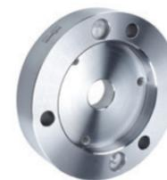
Den Aufnahme- flansch für Zylinder mit Kurzkegel gibt es in den Kegelgrößen 5, 6, 8, 11. Die Verschraubung gibt es in den Größen ISO 702-1 (DIN55026, Verschraubung), 701-2 (DIN55029, Camlock) und 702-3 (Stehbolzen mit Mutter). Die Flansche passen auch auf den CoAE mit Zentrieraufnahme.
