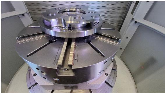
Planetenträger – hochpräzise gefertigt mit Röhm-Spannmitteln
