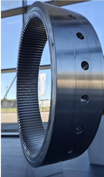
RENK Rheine fertigt Getriebe- und Kupplungslösungen für Kunden weltweit auch im XXL-Format, hier ein Hohlrund von einem Planetengetriebe
