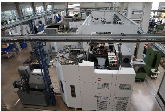
Gesamtblick auf die Anlage: Die Hermle Automationslösung RS2L bedient drei Hermle Bearbeitungszentren C42. Bild: RÖHM GmbH
