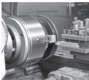
Torneado exterior de garras no templadas
