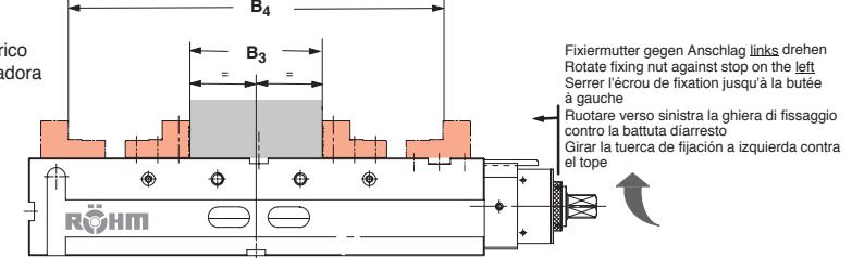
Backenbreite – jaw width – largeur des mors – largh. ganasce – ancho garra
