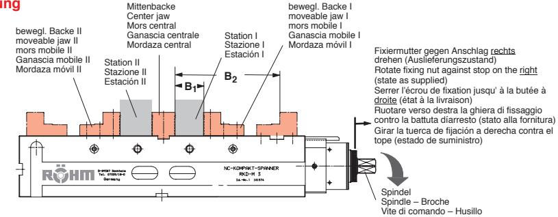
Backenbreite – jaw width – largeur des mors – largh. ganasce – ancho garra
