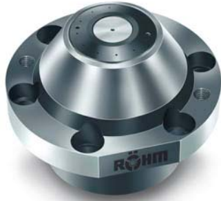
Bild Nr. 10-01 RM_DM-Spannkopf.jpg Die Segment-Spannzange schließt sich um den Anzugsbolzen, zieht ihn automatisch auf den Aufnahmekegel und verriegelt mechanisch.
