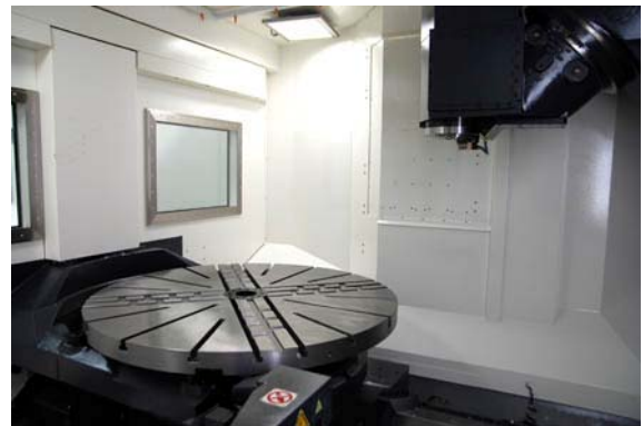
Bild Nr. 10-06 RM_DM-PaletteGross.jpg Beim 5-Achsen-Bearbeitungszentrum DMC 160U duoBlock® können Werkstücke bis 3.000 kg auf bis zu 1.400 mm Durchmesser großen Paletten sicher gespannt werden.
