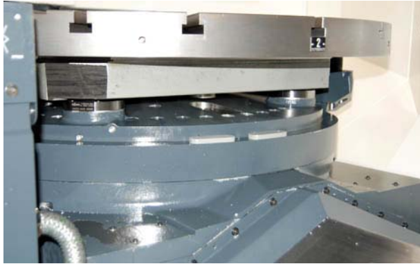
Bild Nr. 10-05 RM_DM-Zentrierung.jpg Die Palette wird immer 3-achsig positioniert. Das sorgt für guten Planlauf von 0,01 mm.
