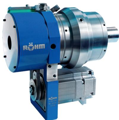
Elektro-Hohlspanner EHS zur Betätigung von Spannfütern mit Stangendurchgang. Speziell geeignet für das Spannen von Stangenmaterial von bis zu 67 mm Außendurchmesser auf Dreh- und Schleifmaschinen.
