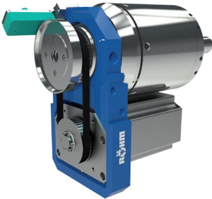
Elektro-Vollspanner EVS zur Betätigung von Spannfuttern ohne Stangendurchgang. Speziell geeignet für das sichere und energieeffiziente Spannen von Werkstücken auf Dreh- und Schleifmaschinen.
