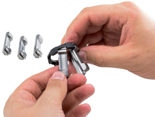
Montage der Spannzangensegmente
