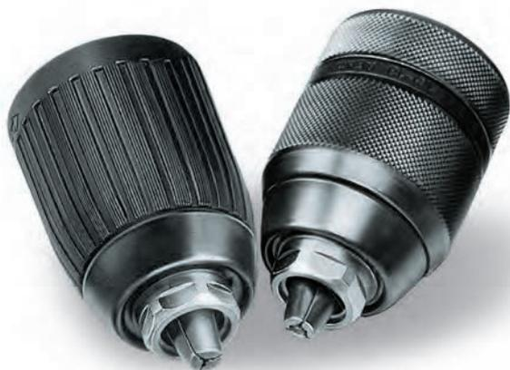
Schlüssellose Bohrfutter in Kunststoff- und Metallausführung, mit Radialverriegelung, für Netzbohrmaschinen und Akkumaschinen, schlagbohrfest, mit Sechskant für Montage und Demontage auf der Maschinenspindel
