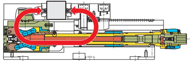
Der Spannkraftverlauf garantiert, dass der Körper beim Spannvorgang verformungsstabil bleibt und höchste Spanngenauigkeit erreicht wird.
