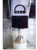
Bild Nr. 35-07 RM\_IW- AufzugswelleBohrung2.jpg Even the drill hole for the winding shaft can be machined without a change of clamping position. © Benedict Walther für Röhm
