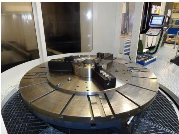
Mehr Flexibilität in der Anwendung: Mit dem DURO-TA XT von Röhms werden Rüstzeiten deutlich reduziert.
