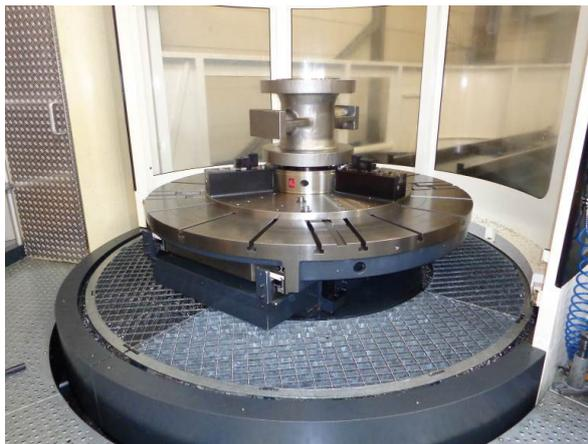
Die Duro-TA XT Futter von Röhms in beeindruckenden 1200 mm Durchmesser zeichnen sich trotz Größe durch eine kompakte Bauweise, Werkstückzugänglichkeit, Flexibilität und Spannkraft aus.
