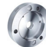
La brida de acoplamiento para cilindros con cono corto se ofrece en los tamaños de cono 5, 6, 8, 11. El racor está disponible en los tamaños ISO 702-1 (DIN55026, racor), 701-2 (DIN55029, Camlock) y 702-3 (espárrago con tuerca). Las bridas también son compatibles con el CoAE con asiento de centrado.
