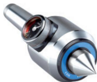
En el lado del (contrapunto o cabezal secundario) se recomienda utilizar un punto con medición de fuerza integrada, p. ej., el punto de control (medidor) de Röhm.
