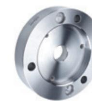
O flange de fixação para cilindros com cone curto está disponível nos tamanhos cônicos 5, 6, 8, 11. A união roscada está disponível nos tamanhos ISO 702-1 (DIN55026, união roscada), 701-2 (DIN55029, Camlock) e 702-3 (pino roscado com porca). Os flanges também são adequados ao CoAE com fixação de centragem.
