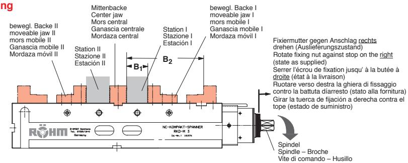
Backenbreite – jaw width – largeur des mors – largh. ganasce – ancho garra
