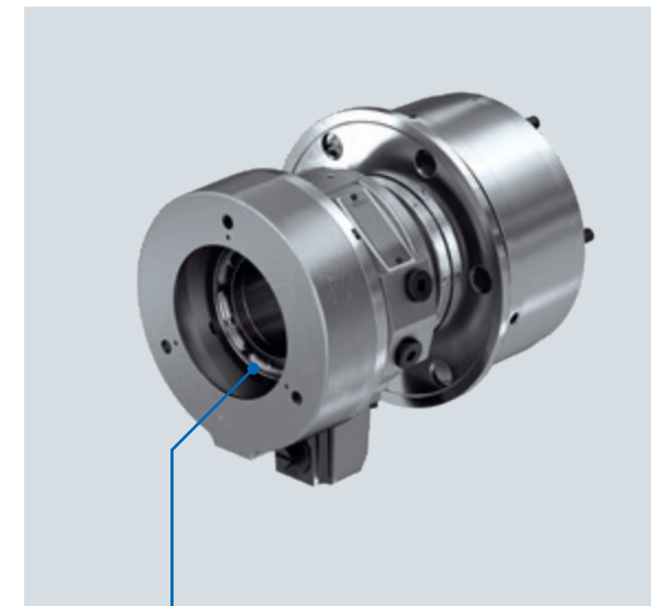
À l'arrière, le Forto-HT dispose, sur la bride rotative, plusieurs trous taraudés pouvant être utilisés pour la liaison avec une butée longitudinale, avec un tube de guidage de la matière ou avec un raccord rotatif.
