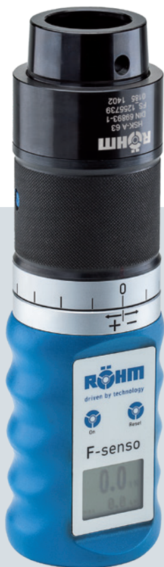
Измерение усилия зажима при помощи F-Senso Spindle
