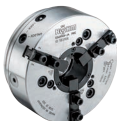
Uchwyty tokarskie z szybko-wymiennymi szczękami
