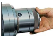
Drehen: Futterdeckel um 45° drehen, bis sich „Auf“ mit der Futtermarkierung deckt
