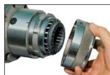
Abnehmen: Deckel abziehen und Spannzange entnehmen
