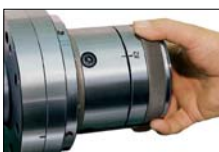
Eindrücken: Futterdeckel ganzflächig 2 mm gegen Maschinenspindel drücken
