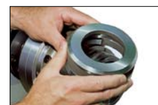
Bajonett-System: Futterdeckel kann jeweils um 90° versetzt auf das Futter aufgesetzt werden
